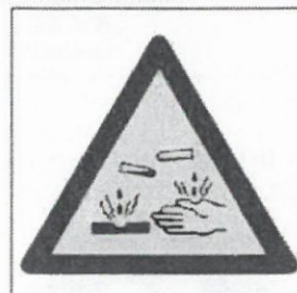
Ref. 350 Peligro de corrosión
